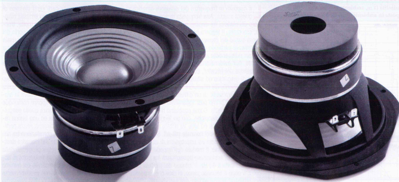
I woofer da 165 millimetri hanno la membrana con i caratteristici anelli ondulati dei diffusori professionali. Notare la sospensione in gomma ed il secondo anello di ferrite. Il cestello è in pressofusione e la bobina mobile è da 38 millimetri.
